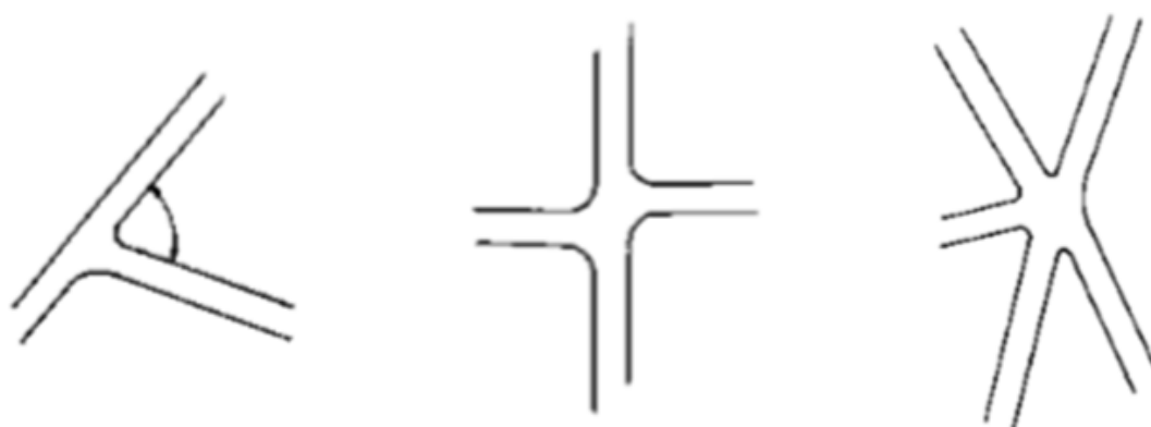
Figura 2.6 - Critério do número de ramos: interseções de três ramos, quatro ramos e ramos múltiplos (da esquerda para direita)
